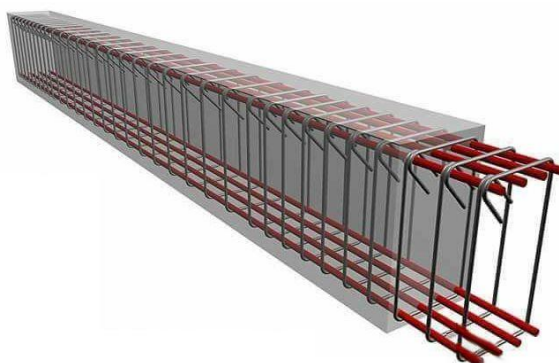
Figura 1 – Representação gráfica de uma peça de concreto armado.
