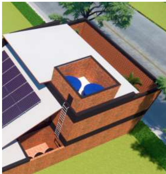
Figura 59 - Cisterna de 2.000 litros instalada na torre da edificação. Fonte: Autora (2020).
