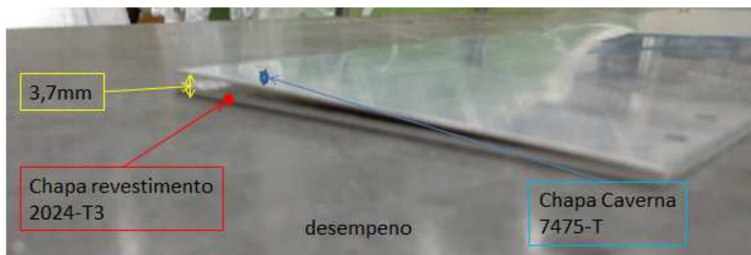
Figura 13 Verificação das Chapas utilizadas no CDP antes da cravação.; próprio autor
