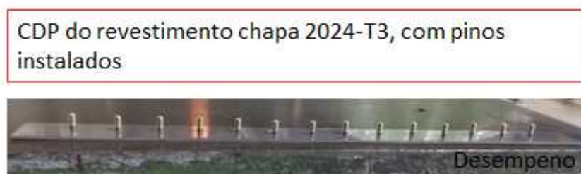
Figura 29 chapa 2024-T3 instalada com pinos, próprio autor
