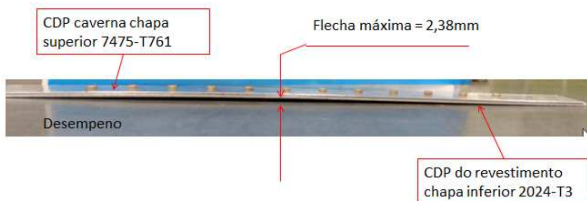
Figura 27 sentido da flecha percebida após a cravação, próprio autor.
