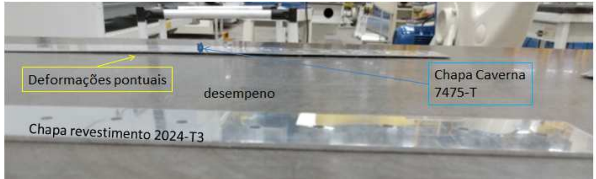
Figura 14 Verificação das Chapas utilizadas no CDP após da cravação.; próprio autor
