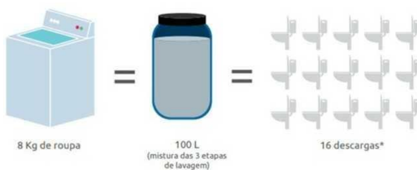
Figura 07. Exemplo de utilização de água cinza
