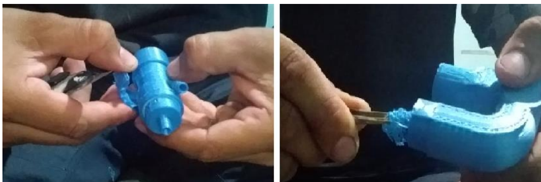
Figura 12: Processo de retirada de suportes das peças.
