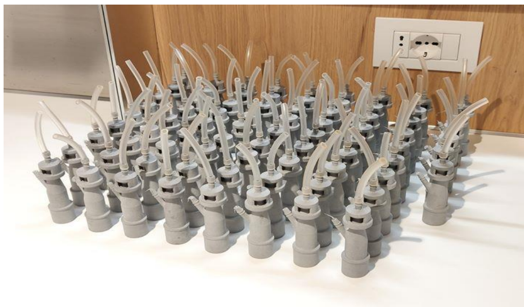
Figura 2: Válvulas Venturi fabricadas através da impressão 3D na Itália.
