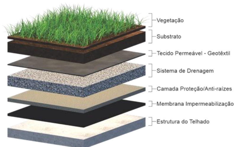
Figura 23: Camadas Telhado Verde
