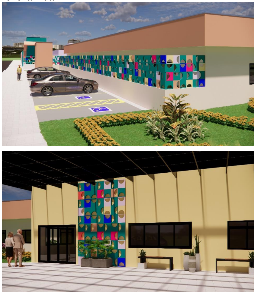
Figura 22 – Cobogós no muro de divisa (acima) e na fachada principal (abaixo), projeto CDI Renova Vida.
