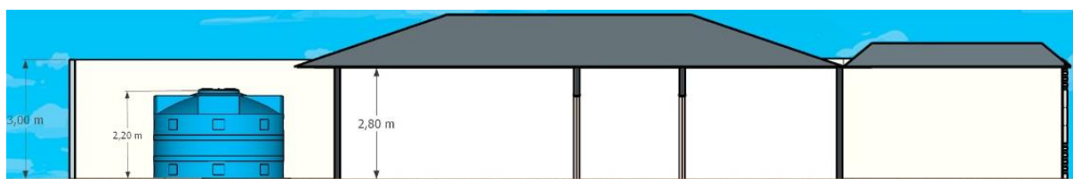
Figura 5. Corte da Cisterna
