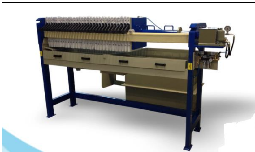
Figura 2 – Filtro Prensa de Placas para Secagem de lodo Fonte – Imagem disponibilizada pela internet (ÁGUAS CLARAS ENGENHARIA).
