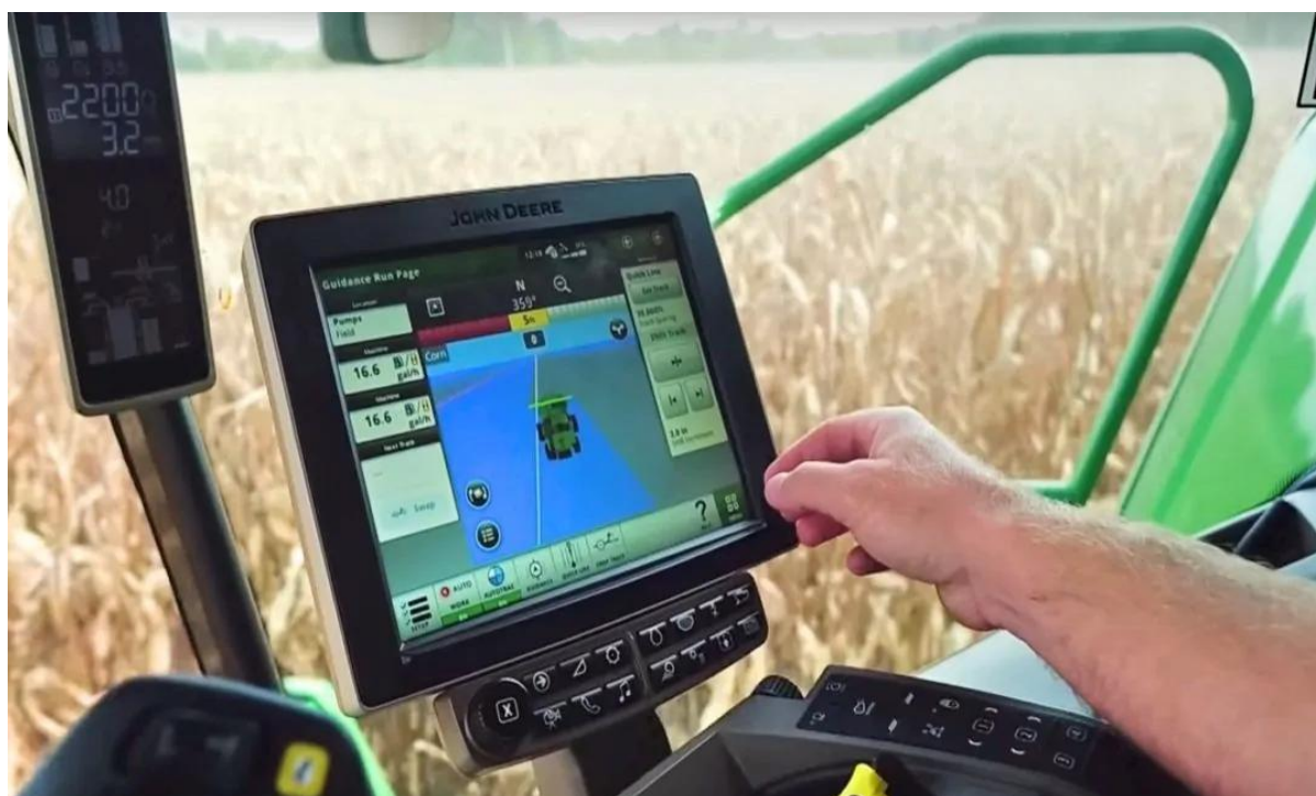
Figura 1 – Sistema de orientação por GPS em cabine de máquina agrícola.
