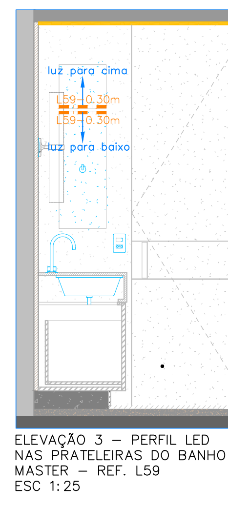
ELEVACÃO 2 - PERFIL LED NAS PRATELEIRAS DO BANHO MASTER - Ref. L59 ESC 1:25
