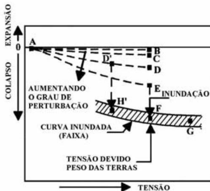
Figura 8: Representação esquemática do resultado da inundação em solos colapsáveis
