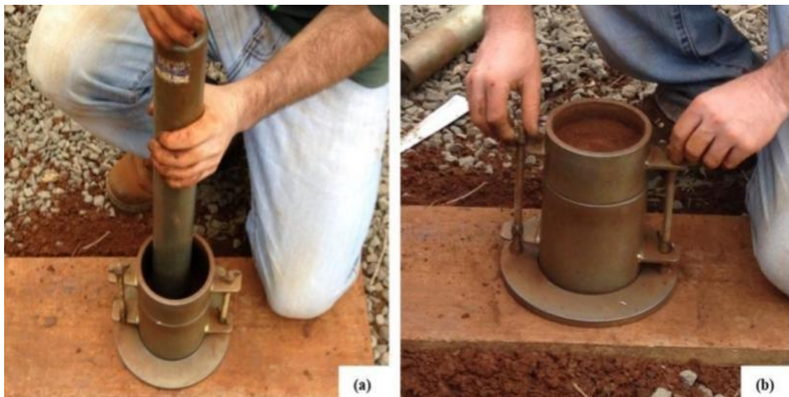
Figura 8. Cilindro e soquete do conjunto utilizado no ensaio (a) e cilindro preenchido com a terceira camada de solo compactada (b). (Fonte: Ribelatto et al., 2017).
